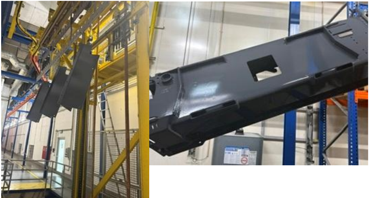
Abbildung 5 und 6: Vorbehandeltes Bauteil auf dem Weg durch den Lackierprozess. Bildbeschreibung: Vom gereinigten und vorbehandelten Bauteil über die Lackierung bis zum fertig beschichteten Endprodukt. Die Wasserqualität bildet dabei einen entscheidenden Baustein für eine gleichmäßige und saubere Oberfläche. Fertig beschichtetes Bauteil mit gleichmäßiger Lackoberfläche.
