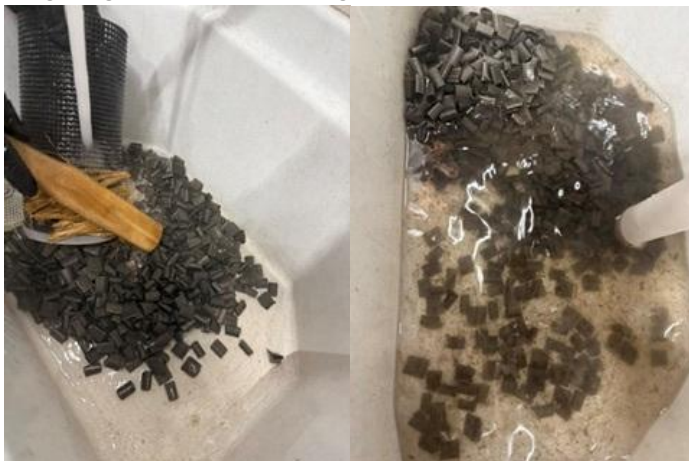
Abbildungen 2 und 3: Ausgetragene Rückstände, Biofilmreste und Ablagerungen im Prozesswasser nach einer Woche Betriebszeit. Erkennbar sind dunkle Partikel, Biofilmreste und abgelöste Verunreinigungen im Bereich der eingesetzten Geweberinge.
